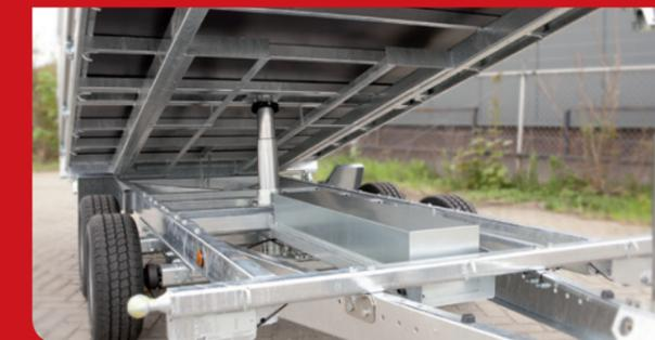
Batterie et pompe hydraulique dans caisse protectrice au chassis.
