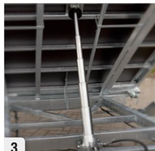
Vérin très puissant (5 cylindres) inclinaison 48° (force de traction 6100 kg)
