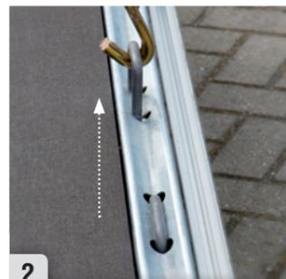
Anneaux d'arrimage (force de traction 950 kg) intégrés
